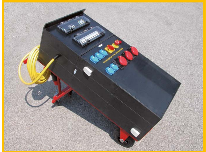
EDP No. 79337, 24 kVA
