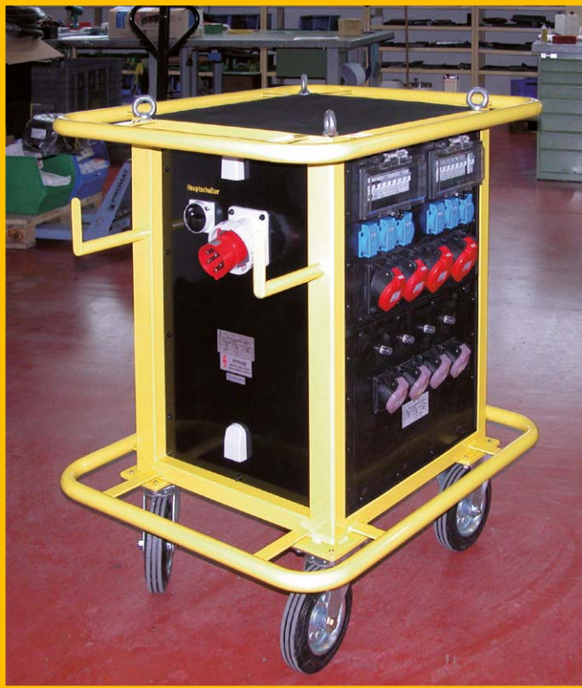
EDP No. 80274, 30 kVA 400V, 2 kVA 24V
