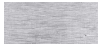
Plech s krížovou kresbou po brúsení (trieda odolnosti proti klzaniu)
