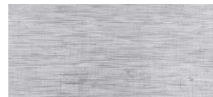
Plech s križovou kresbou po brúsení (trieda odolnosti proti kĺzaniu)
