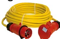
15m Proflexx 5x2,5mm<sup>2</sup>, Kunststoff CEE-Stecker und Kupplung 5x16A 400V
