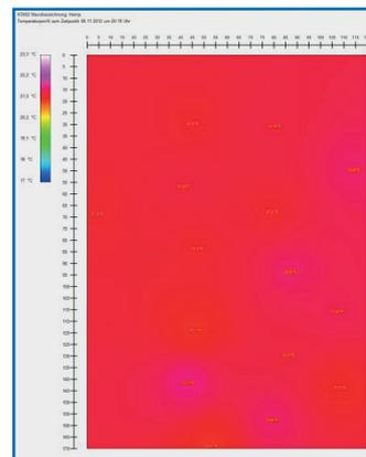
Innerhalb kürzester Zeit nach Zuschaltung der Turbulatoren ergibt sich ein homogenes Raumklima hinsichtlich Temperatur und Luftfeuchte in der Halle.
