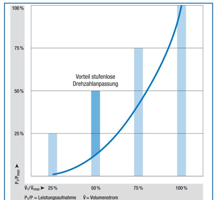
**Geringere Energieaufnahme: Die Balken zeigen die Leistungsaufnahme von Ventilatoren, die zu- oder abgeschaltet werden. Die blaue Linie zeigt die Leistungsaufnahme bei stufenloser Drehzahlanpassung.**
