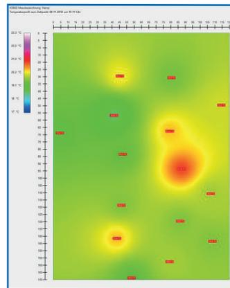
Die Heizsysteme sind in Betrieb aber es zeigen sich typische Kälte und Wärmepolster mit ungleichmäßiger Temperaturverteilung.
